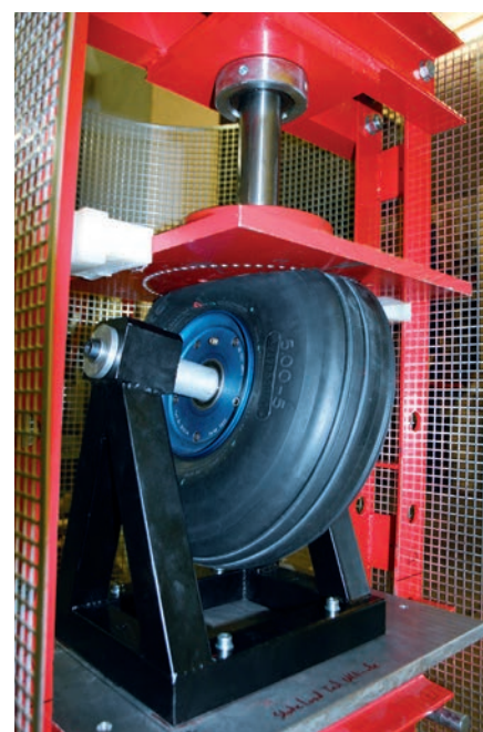
Statischer Belastungsversuch einer bereiften Felge
