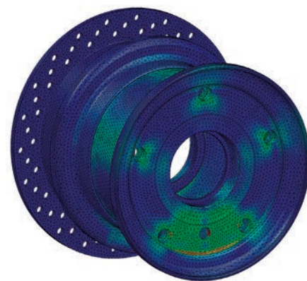
FEM-basierte Analyse eines Pentascheibenbremsrads
