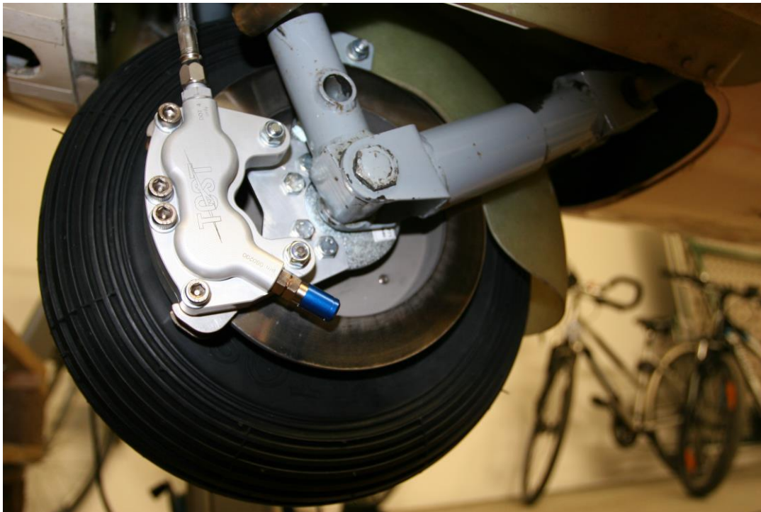
Abbildung 4.2: montierte Bremszange / mounted brake calliper
